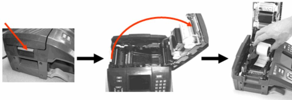
4. Führen Sie das Ende des Etikettenbandes bis zur schwarzen Linie unter den Rippen.
