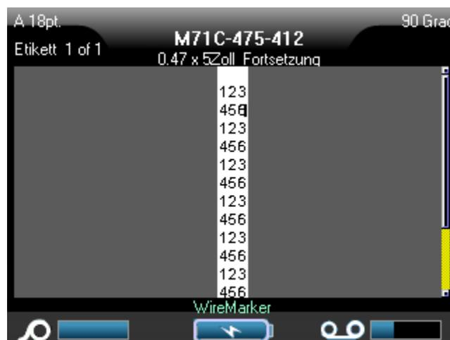
Abbildung 32 • WireMarker-Label mit mehreren Zeilen
