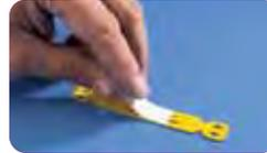
3) Bringen Sie die Schutzfolie auf dem Träger auf. Drücken Sie hierbei mit einem Finger auf die Folie, bewegen Sie den Finger langsam vorwärts und ziehen Sie gleichzeitig das Silikon-Trägerpapier ab.
